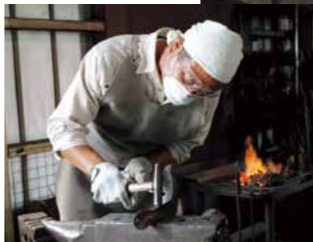
柄の部分は変形しやすく、成形するには微妙な力加減が必要
